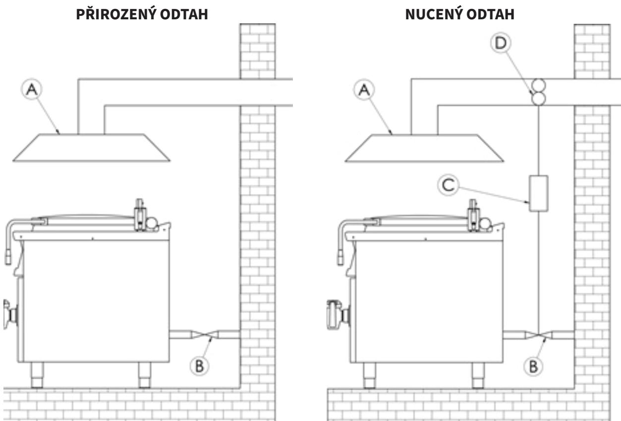
Vyústění digestoře je do samostatného komínového tělesa (A). Odtah spalin zabezpečuje přirozený tah komínu.
